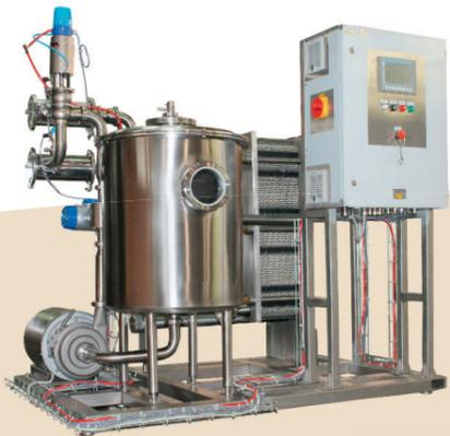
Для повышения качества принимаемого молока, в состав модуля могут быть добавлены сепараторы-молокоочистители и сепараторы для удаления бактерий, управление которыми полностью синхронизировано с работой модуля, емкостное оборудование. Система управления позволяет проводить сбор, архивирование и передачу данных об объемах и качестве принятого молока в локальные сети предприятия. Производительность модулей приемки молока Ж5-Плава-ОП-КО достигает 35 000 л/час.
