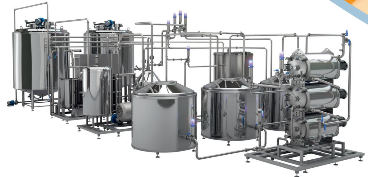
Производство масла с любым содержанием жира полностью автоматизировано, что влечет за собой повышение эффективности: снижение затрат на оплату труда, снижение потерь сырья и готового продукта, отсутствие влияния человеческого фактора на производство. Автоматизация позволяет подключить линию к СІР-мойке и интегрировать линию в SCADA и MES-системы.
