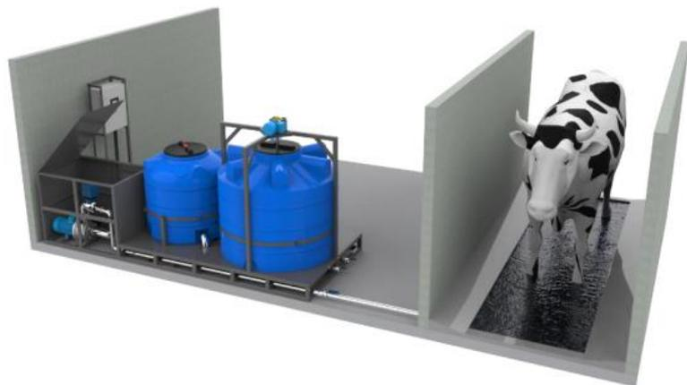
Система из двух емкостей, механической мешалки и насосов, автоматически готовит: концентрат и готовый раствор для дезинсекции копыт; подаёт раствор в копытную ванну; сливает и промывает копытную ванну.
